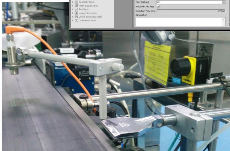
∞ 6. Послойная укладка продукции в третичную упаковку и считывание DataMatrix-кодов с помощью камеры машинного зрения
